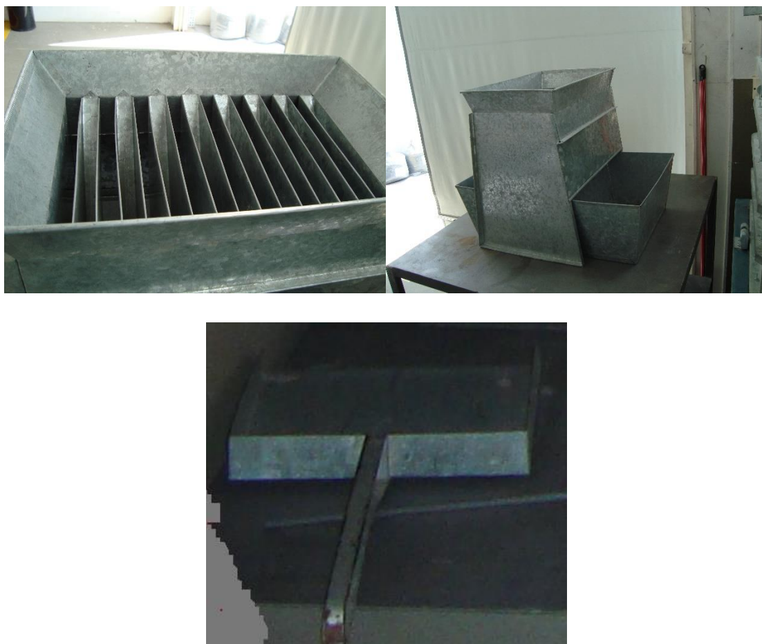
Figura 1 – Repartidor de Amostras (cascata) e acessórios
