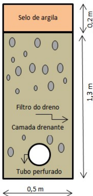
Figura 1 - Dreno longitudinal profundo
