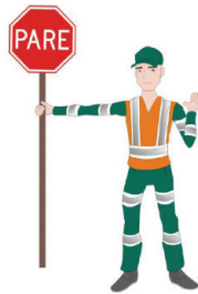
Figura 43 - O Operador mantendo sinal de “PARE” voltado para o fluxo de veículos e gesto de mão espalmada
