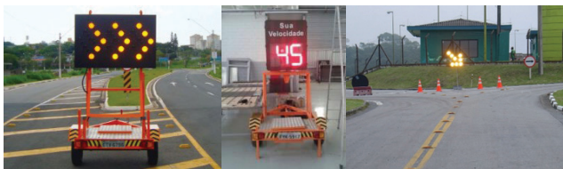
(a) Painel tipo SETA (a); informador de velocidade/carretaradar (b); seta luminosa (c)
